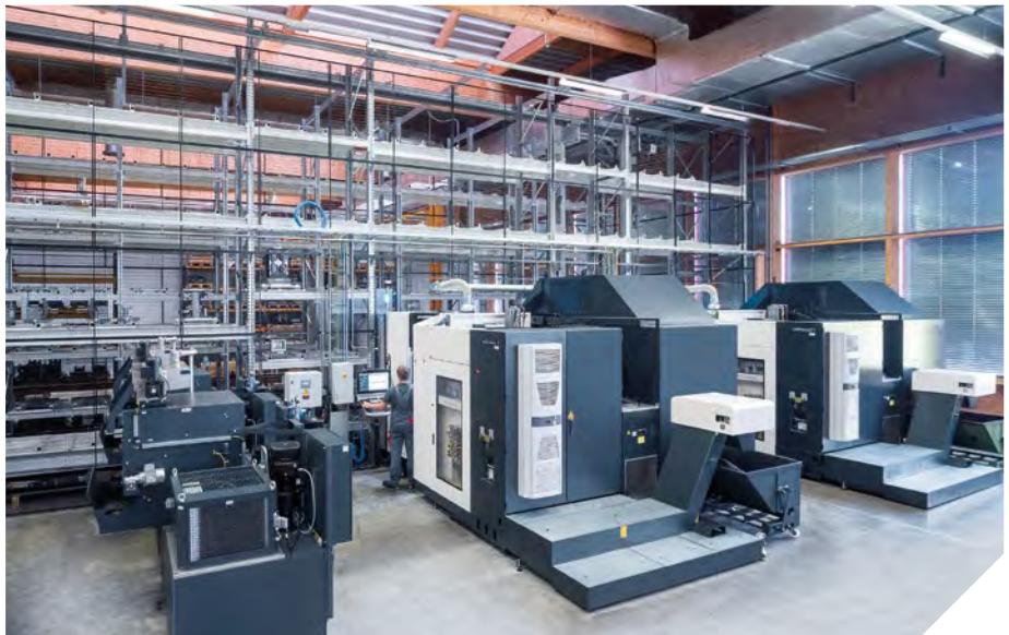
两台DMC 60 H linear 加工中心连接100盘位的托盘交换系统。结合303位刀库，夜间和周末都能自主地生产。
