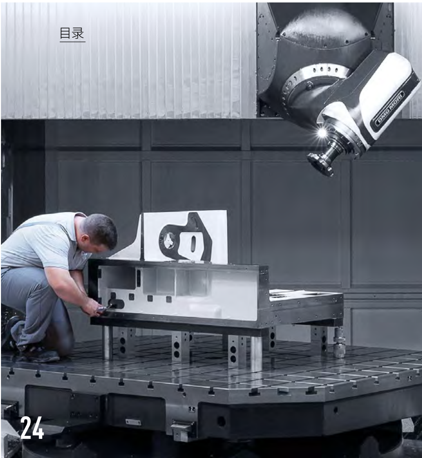
24 Baltic Metalltechnik: 45台DMG MORI机床高精度地加工, 精度达10微米, 其中DMC 340 U加工中心加工的工件长度达3m。
