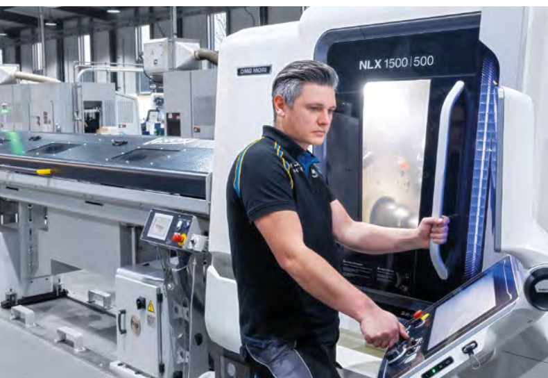
一名机床操作员负责两台NLX 3000车削中心和一台配棒料送料机的NLX 1500自动车削中心。
