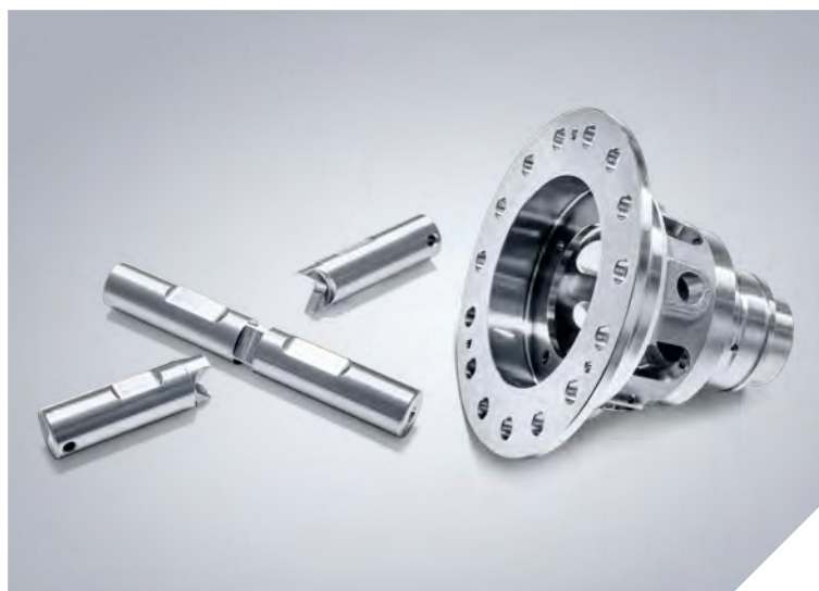
用NLX 1500车削中心加工限滑差速器上的差速齿轮轴(左)和用两台NLX 3000车削中心加工差速器壳(右)。
