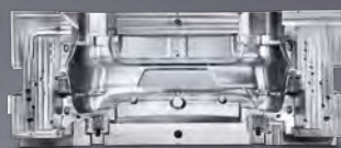
模具 / 汽车 汽车保险杠模芯 尺寸: 2,800 × 1,500 × 1,255 mm 材质: 工具钢 纹理: 精细纹理
