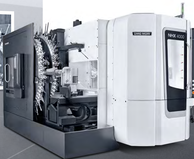
外刀轮63刀位, 内刀轮60刀位。
