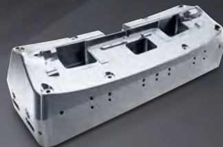
模具 / 汽车 内饰模芯 尺寸: 1,630 × 490 × 405 mm 材质: 工具钢 纹理: 蜂窝结构
