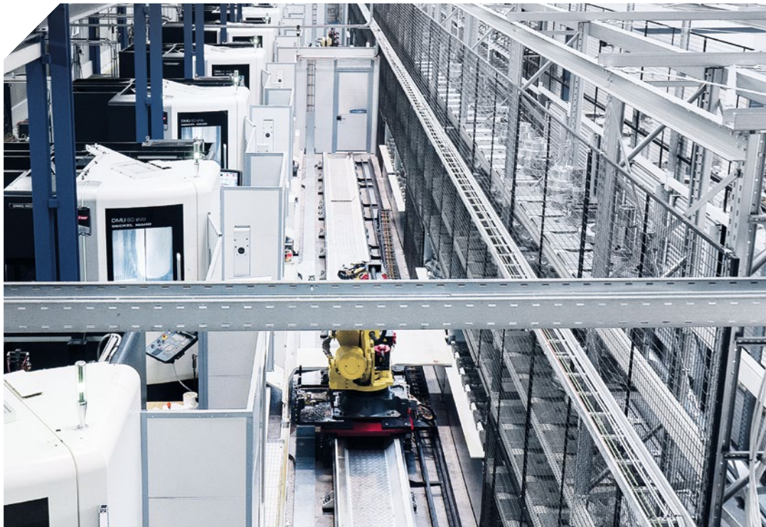
PFW将12台DMU 60 eVo linear 加工中心通过多达743盘位的托盘库连接在一起。
