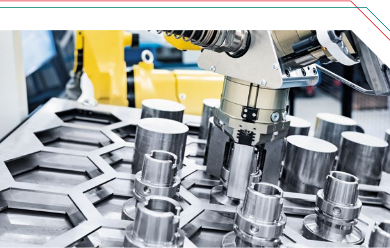
对于不同直径工件，Robo2Go自动计算工件的中间点，确保准确地抓取工件。
