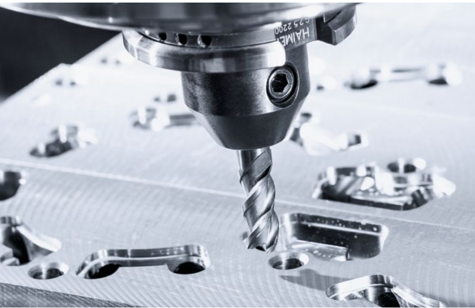
挤压吹塑模的生产包括从钻削冷却系统和铣削粗加工和精加工, 因此需要灵活通用的加工中心。
