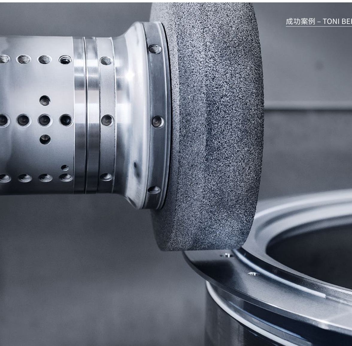
带磨削套件的DMC 125 FD duoBLOCK 加工中心允许一次装夹进行铣削、车削和磨削加工。
