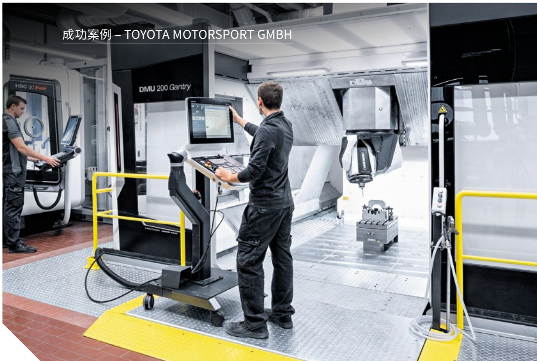
将DMU 200 Gantry安装在地坑中,使敏感的碳纤维部件可在地面上用叉车装件和卸件。
